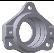
ЗС-20.03.001 Корпус под-ка Материал: СЧ20. m = 0,85 кг.
