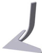
Н.043.04.010 Стойка с лапой m = 1,62 кг.
