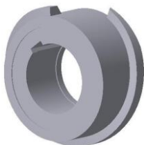
ПМ-400.00.072 Виток Материал: Ст45б. m = 5,8 кг. Ø=162 мм. h=65 мм.
