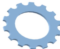
СКО-Ф-6.00.202 Звездочка Материал: Ст45; m = 1,9 кг; S = 12 мм.
