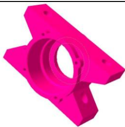
ЛДГ-10М.05.005 Корпус под-ка Материал: СЧ20. m = 4,8 кг
