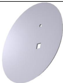
ЛДГ-10М.05.001 Диск Материал: Ст65Г.м = 7,35 кг.
