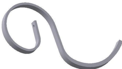
АП-6.03.601 Лапа культиваторная Материал: 55С2. m = 2,8 кг.
